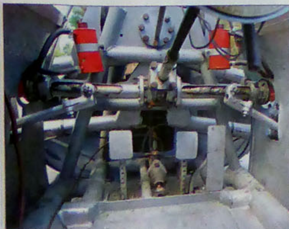
De chaque côté de la direction, deux réservoirs hydrauliques alimentent les vérins avant. le même système, au dessus du train arrière, permet de basculer toute la voiture autour des deux axes. Les vérins fonctionnent par couples, gauche et droite.
